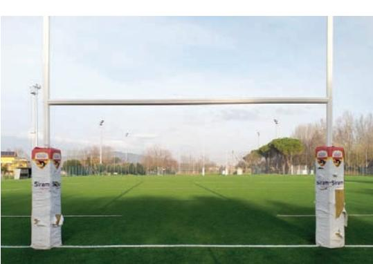
Il manto Trishape è composto da una speciale fibra con particolare forma a tre sezioni combinate e legate, non ritorte, con ispessimento centrale di rinforzo a diamante. La particolare struttura a tre sezioni, la zigrinatura superficiale e lo speciale polimero di polietilene, garantiscono durabilità e un ottimo comfort di gioco.
